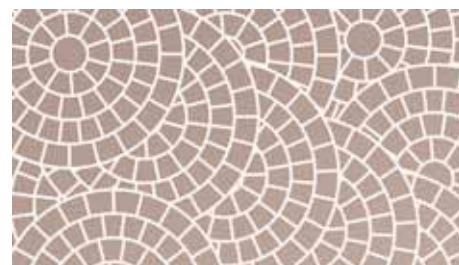
Mosaikpflaster · mosaic laying
