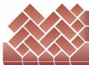
Verlegung mit Bischofsmützen
