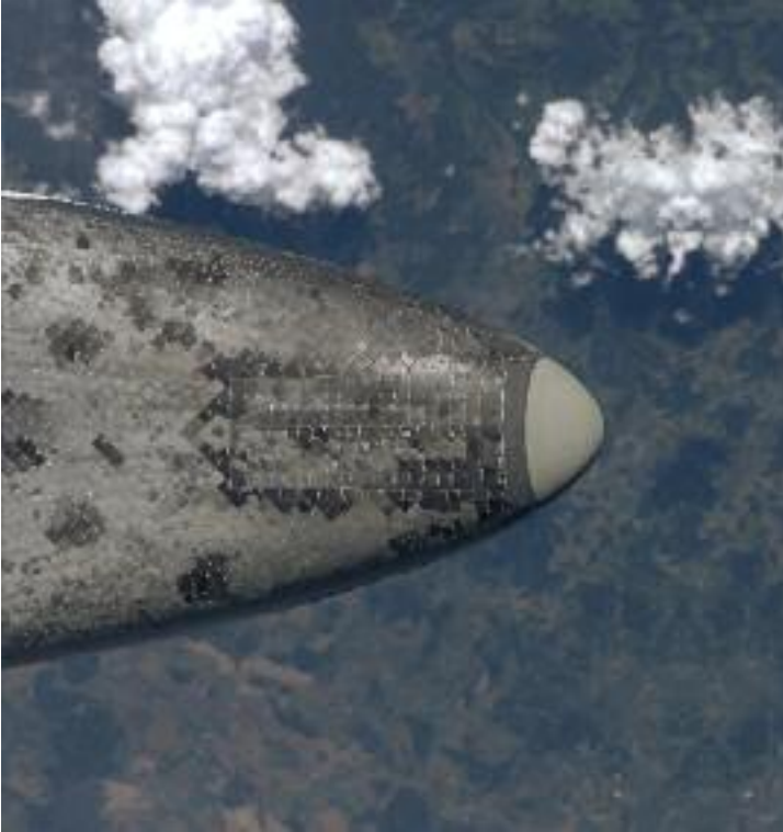
Keramisches Hitzeschutzschild Space Shuttle
